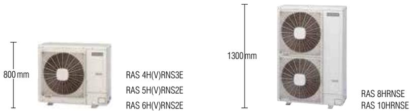
Серия ES представлена однофазными и трехфазными моделями наружных блоков с номинальной производительностью от 7,1 до 28 кВт. К одному наружному блоку можно подключить до 4 различных внутренних блоков, при этом максимальная длина трубопроводов достигает 50 метров. Внутренние блоки в комбинации с ES серий не имеют воз-
