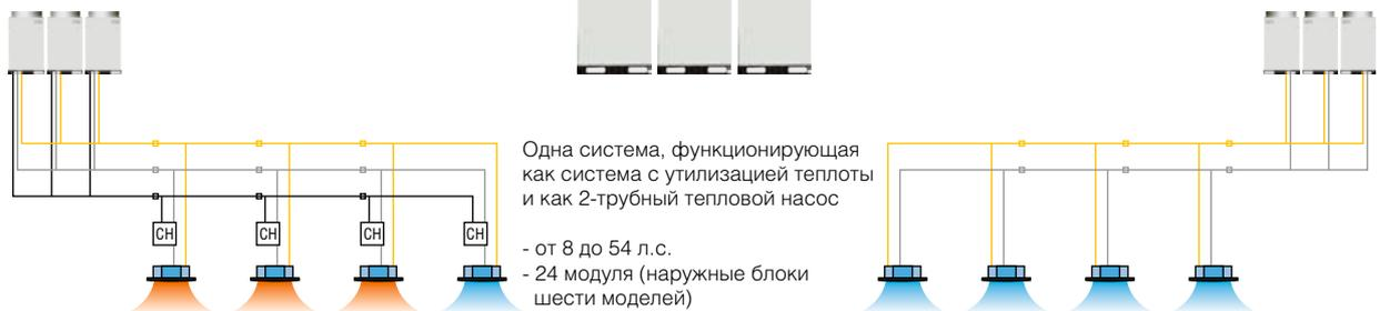
Одна система, функционирующая как система с утилизацией теплоты и как 2-трубный тепловой насос
