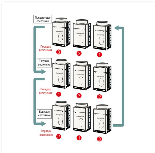
В случае отказа одного из внешних блоков система продолжает работу за счет других внешних блоков того же холодильного контура. Аварийный режим активируется с пульта дистанционного управления одновременным нажатием и удержанием в течение 3 секунд кнопок управления температурой.
