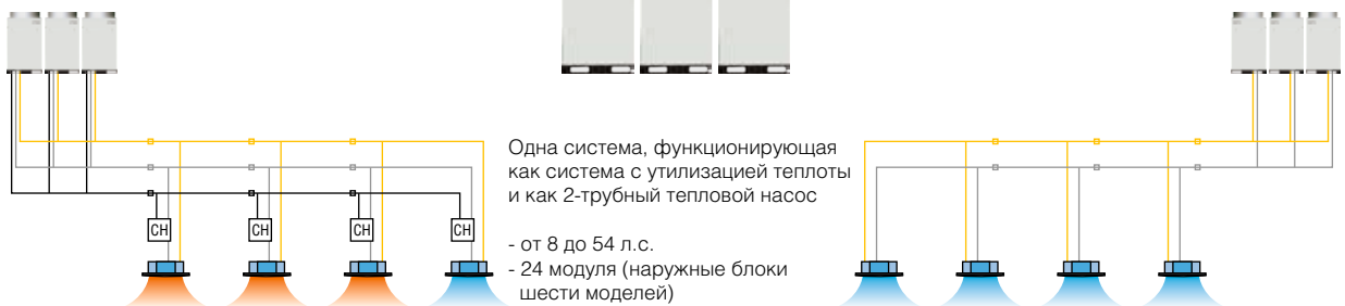
Монтаж 3-трубной системы с утилизацией тепла (с применением блоков CH)
